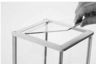
3) Install Top Door
